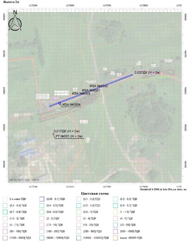
Вариант расчета: Газопровод межноселковый (711) - Расчет рассеивания по MPP-2017 [11.07.2024 14:48 - 11.07.2024 14:49] , ЛЕТО
